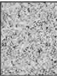
EDM-4 は、優れた特性を持つ微粒子グラファイト材です。この同位性の高いグレードでは、高い強度と適度の硬度が組み合わされており、電極加工において優れた特質を発揮します。また、金属除去率、耐磨耗性、表面仕上げにも非常に優れています。
