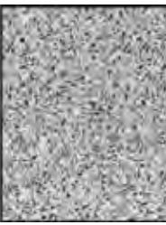
EDM-3 は、同位性のあるグレーンサイズの微粒子高密度グラファイト材です。磨耗に強く、表面仕上げに優れ、0.1mm 以下の薄板も容易に製作できます。
