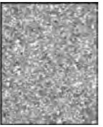
EDM-C200 は、銅を含浸させた高密度グラファイト材で、金属除去率と耐磨耗性に優れています。フラッシングの条件が良くない場合でも、切断の精度を安定させることができます。航空用の合金などの切断に適した素材です。
