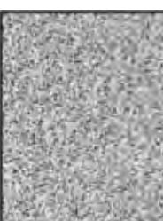
POCO の EDM-AF5 は、平均粒子サイズが 1 ミクロン未満のグラファイト電極原料で、現在市販されている同種類の原料の中でも非常に高品質なものとなっています。この非常に微細な粒子を使用して作られた EDM-AF5 は強度の高い素材構成を持ち、微細な表面仕上げ(7 μ inRa)を可能にし、金属除去率や耐磨耗性に非常に優れています。
