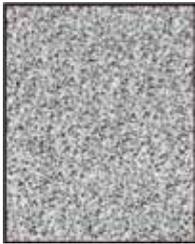
POCO の EDM-AF5 は、平均粒子サイズが 1 ミクロン未満のグラファイト電極原料で、現在市販されている同種類の原料のなかでも非常に高品質なものとなっています。
