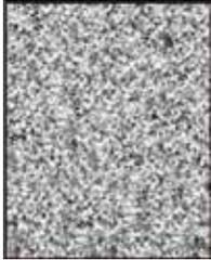
EDM-C3 は、銅を含浸させた高品質グラファイトで、加工の速さ、耐磨耗性、表面仕上げを特に重要視している用途に適しています。微細な電極加工には他に匹敵するものがなく、作業者の経験不足や、フラッシング不足を補えるものとして多くの EDM 技術者から支持されております。
